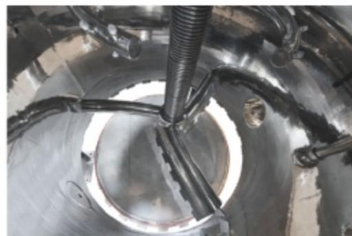
PARTICOLARE DEL SISTEMA DI AGITAZIONE DI UN PRESSOFILTRO®
