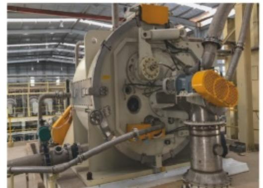
HX/L/S CENTRIFUGA A COLTELLO RASCHIANTE IN UN IMPIANTO PRODUZIONE AMIDO DI TAPIOCA
