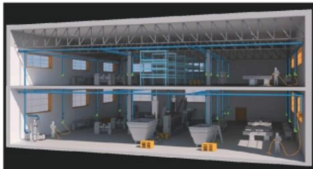
RENDERING DI UN SISTEMA DI ASPIRAZIONE CENTRALIZZATA
