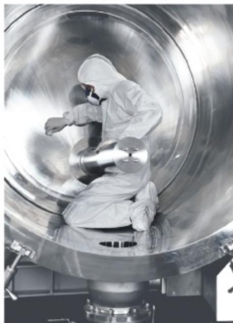
SMONTAGGIO DELLE PALE DELL'AGITATORE
