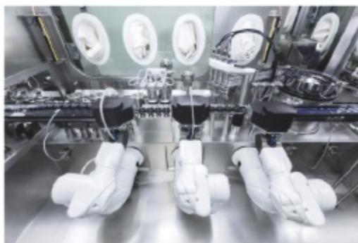
BRACCIO ROBOTICO INSTALLATO SU UNA DELLE MACCHINE ROBOTICHE DI RIEMPIMENTO E DEI FLACONI SOTTO ISOLATORI
